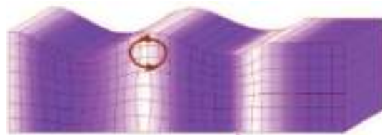
Fig. 2 - Rappresentazione grafica della propagazione delle onde superficiali di Rayleigh caratterizzata dall'oscillazione polarizzata in un piano verticale e con movimento delle particelle retrogrado rispetto alla direzione di propagazione dell'onda.
